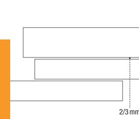
I pavimenti rettificati di Fap devono essere posati con una fuga di 2-3 mm.
